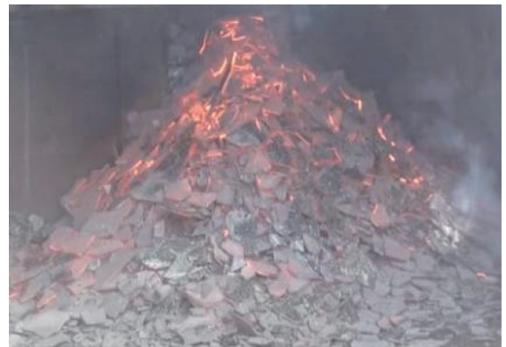
写真3 板状凝固スラグ Photo 3 Plate-like solidified slags
